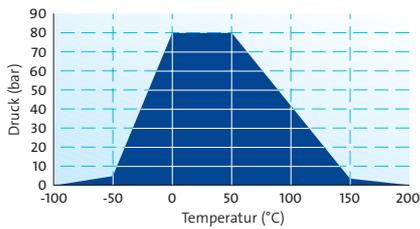
Die Empfehlungen für Temperatur und Druck in den Diagrammen gelten für eine Dichtungsdicke von 2,0 mm und bei Verwendung glatter Flansche. Bei Einsatz dünnerer Dichtungen sind höhere Beanspruchungen möglich!
